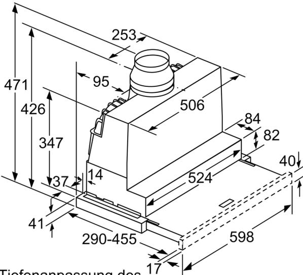
Tiefenanpassung des Filterauszuges bis 29 mm möglich
